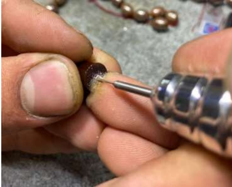
Şekil 3.10. Freze makinesi yardımıyla yuvarlak formlu obsidyenin delinmesi işlemi
