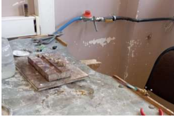
Şekil 3.12. Kaynaklama işlemi için kullanılan Ateş Tuğlası ve Kaynak Şaloma Başlığı
