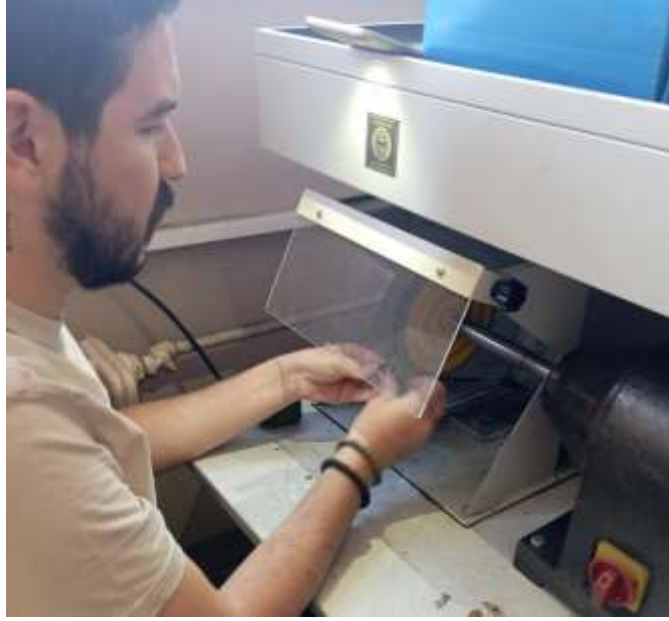
Şekil 3.16. Polisaj makinesinde cilalama işlemi yapılması
