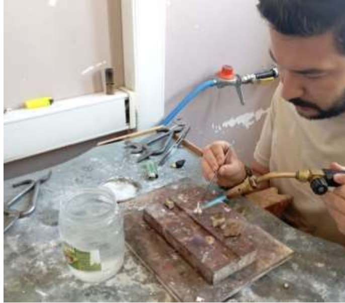
Şekil 3.13. Taş yuvasının ve taş yuvasının astara kaynatılması işlemi
