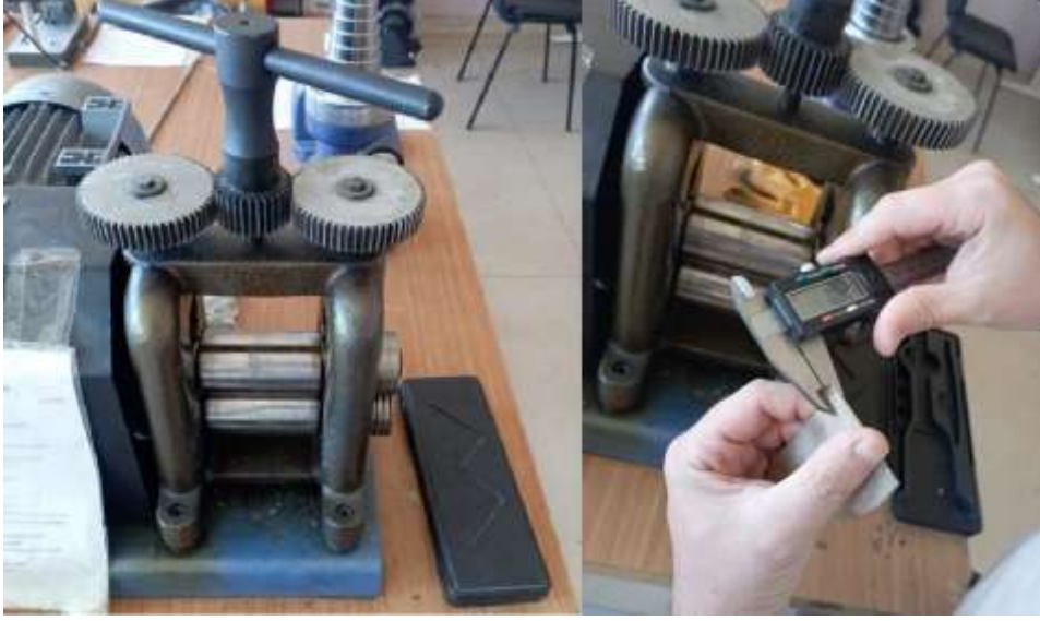
Şekil 3.11. Silindir makinesi ve metal çekme işlemi
