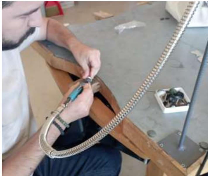
Şekil 3.14. Freze yardımıyla tesviye işlemi
