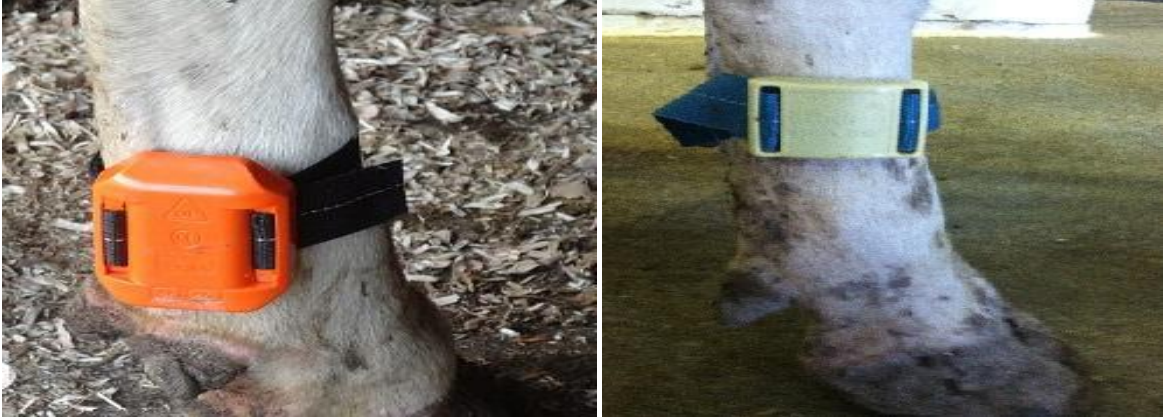
Şekil 2. Yatma ve Ayakta Durma Süreleri Tespit Sensörleri
